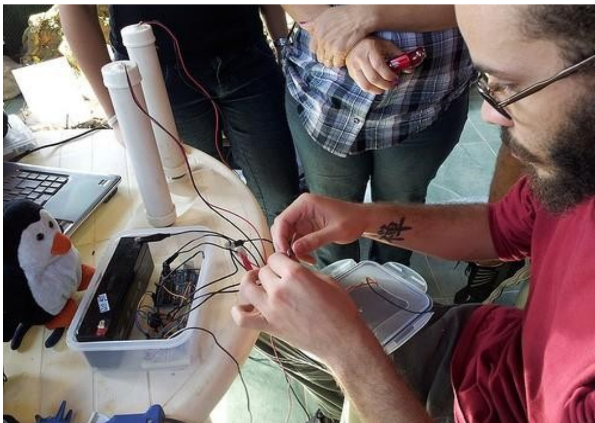
Figura 12: Recipiente com Arduíno para comando do drone (Fonte: Felipe Cabral em 29/09/2012).
